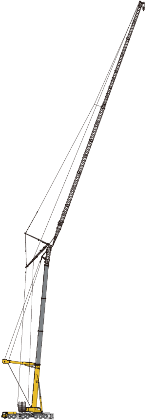
超起变幅副臂（形式一,无主臂加长节）
