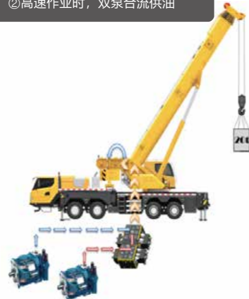
②高速作业时, 双泵合流供油
